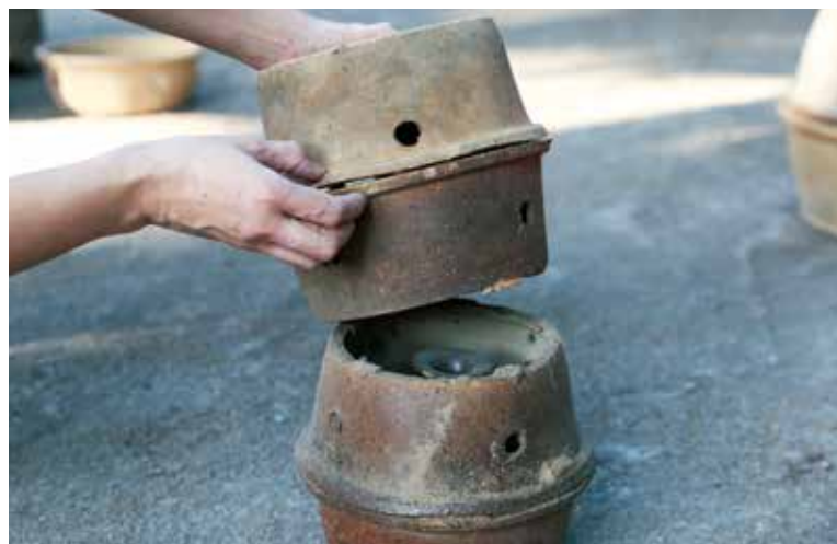
左 匣鉢在燒窯時保護坯體，而且可以疊高，盡用窯內空間。
